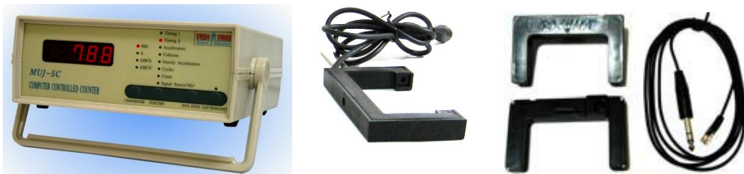
圖 2 永原公司的 MUJ-5C 多功能光電計時器和光電閘(Optoelectric gate)。可隨時自行放大圖片，便可清楚觀測右面板上的各項 LED 的指示和下方四個黑色按鍵的功能。
